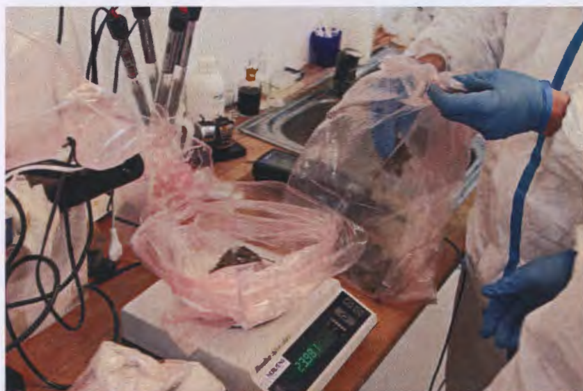
Bilde nr. 23. Bildet viser fordeling av innsamlet materiale på to plastposer i like deler.
