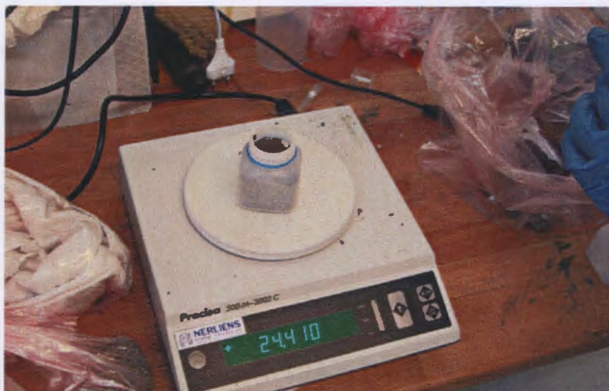
Bilde nr. 26. Bildet viser innsamlet materiale overført fra plastpose til prøvetakingsflaske. Innhold er netto 24.410 gram.
