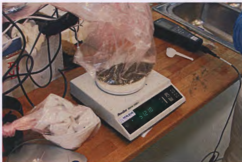
Bilde nr. 25. Bildet viser veiing av nettoinnhold fra den andre plastposen; 51,210 gram. Resten av materialet ble liggende igjen i støvsugerposen ved tømningen.
