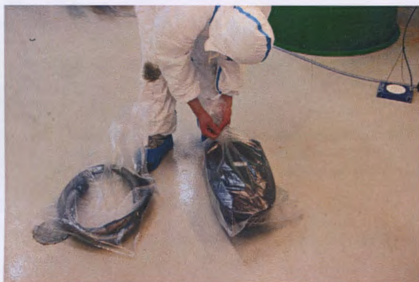
Bilde nr. 27. Bildet viser innpakking og forsegling av støvsuger/støvsugerslange ved bruk av strips. Begge effekter ble destruert etter bruk.
