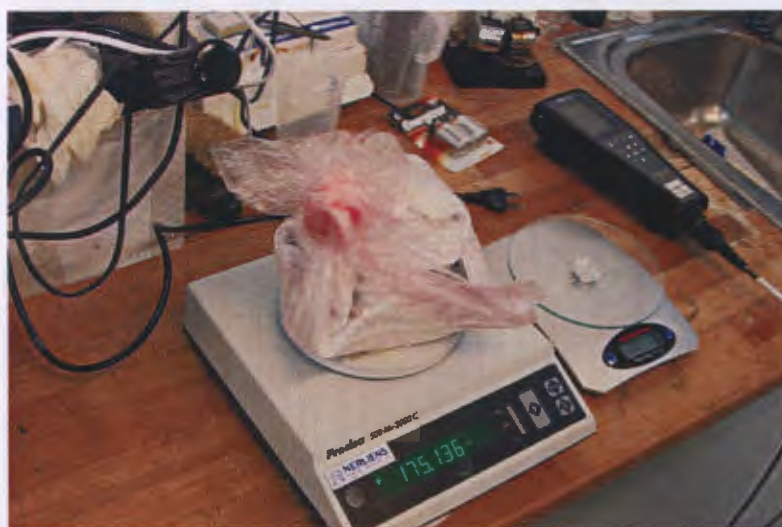
Bilde nr. 19. Bildet viser veiing av støvsugerpose som er lagt inn i plastposen som vist på bilde nr. 18. Før veiing ble vekten nullstilt slik at den nå viser nettovekt uten plastpose (kun støvsugerpose m/ innhold). Samlet vekt er 175,136 gram. Fratrullet vekt av støvsugerposen på 55,952 gram er netto vekt av innsamlet materiale 119,438 gram.
