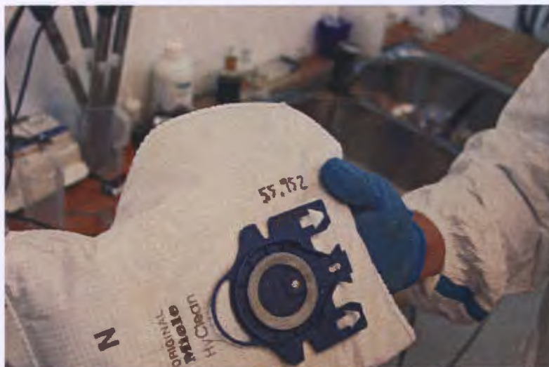
Bilde nr. 18. Bildet viser den posen som ble benyttet til innsamling. Posen ble veid av SLab AS til 55,952 gram i tom tilstand før bruk.
